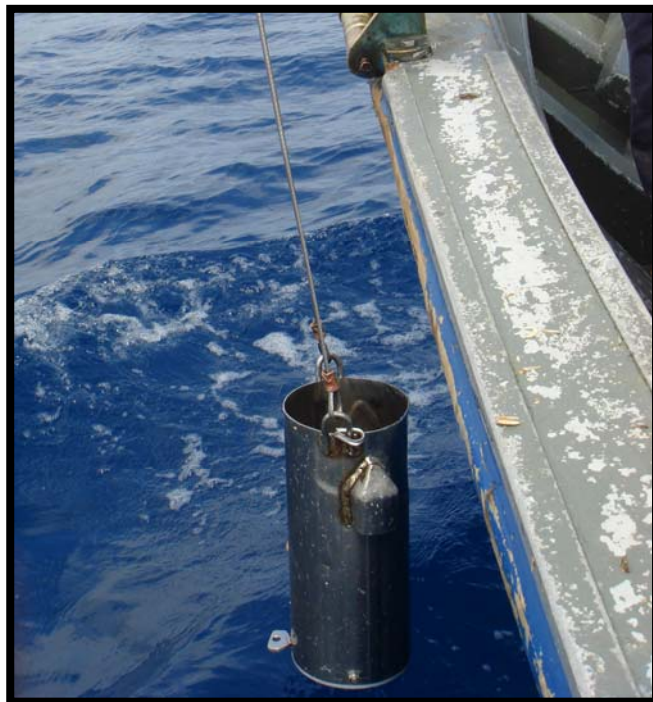
Foto 3.4: Draga empleada para la extracción de sedimento
